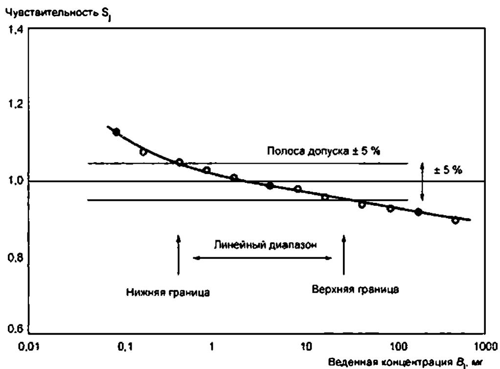
Рисунок 1 — Проверка линейности отклика ECD
